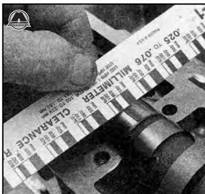
11.11b Сопоставьте ширину раздувального индикатора со значениями в сопровождающей шкале и определите масляный зазор
