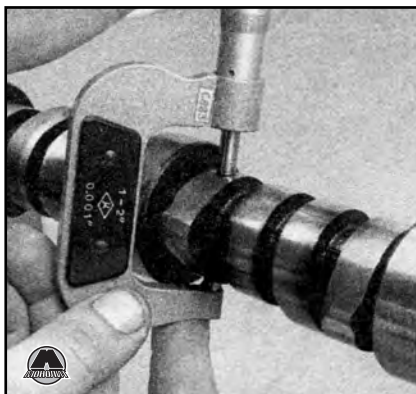
11.10с ... и вычите из полученного результата наименьшую высоту кулачка, получив, таким образом, высоту подъема толкателя
